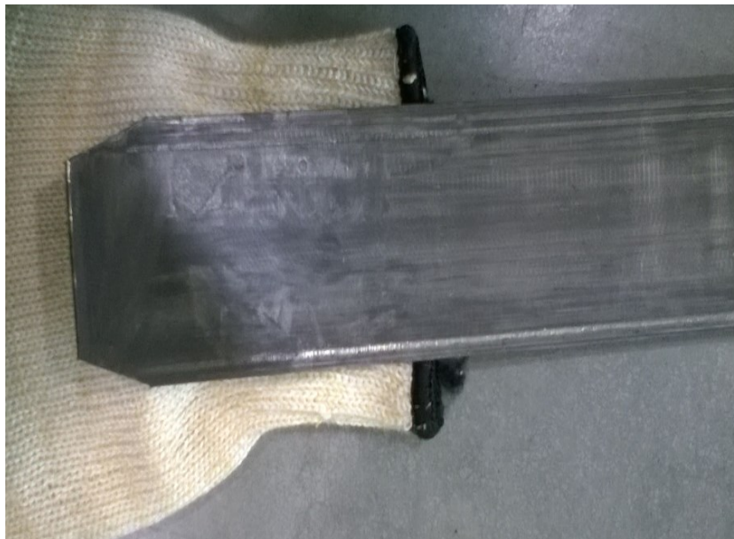
Obr. 12 Úprava hran pásu
