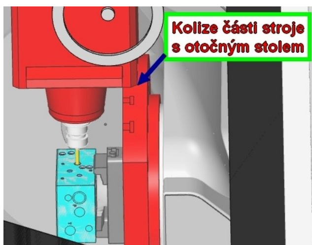
Obr. 28 Kolize stroje s otočným stolem za použití držáku H4C3A0032
