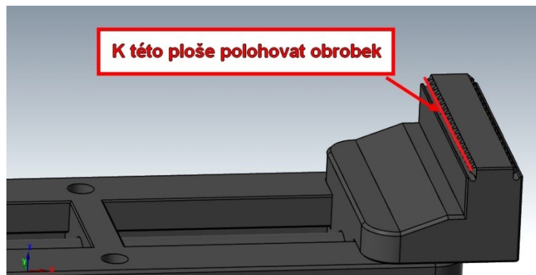
Obr. 17 Upínací plocha upínače k obrobku
