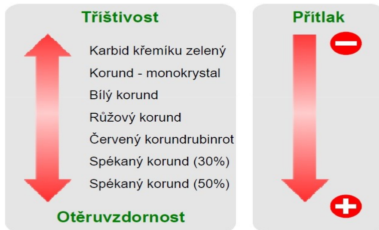
Obr. č. 5.1 – Vhodnost výběru brusného materiálu podle velikosti přítlaku [8]
