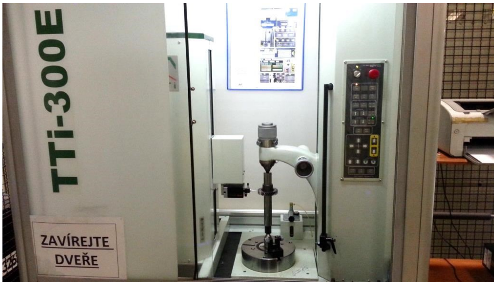
Obr. č. 5.8 – Měření úchylek tvaru profilu na CNC měřícím stroji Tti-300E
