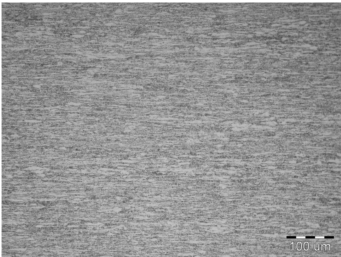
Obr. 24 Mikrostruktura vzorku pro dodaný stav, podélný řez
