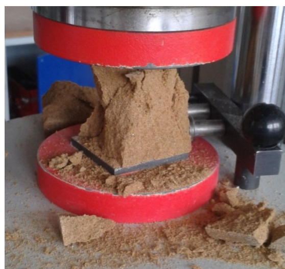
Obr. 24: Zkoušený vzorek po provedení zkoušky pevnosti v tlaku
