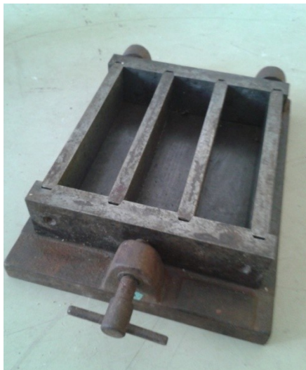
Obr. 19: Forma pro přípravu umělého kamene pojeného cementem
