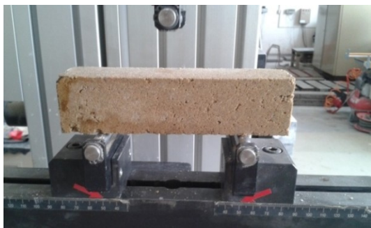
Obr. 21: Zkoušený trámeček před provedením zkoušky pevnosti v tahu za ohybu
