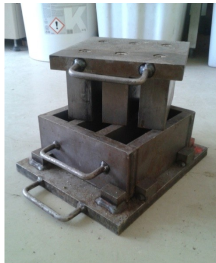
Obr. 20: Forma pro přípravu umělého kamene pojeného vodním sklem
