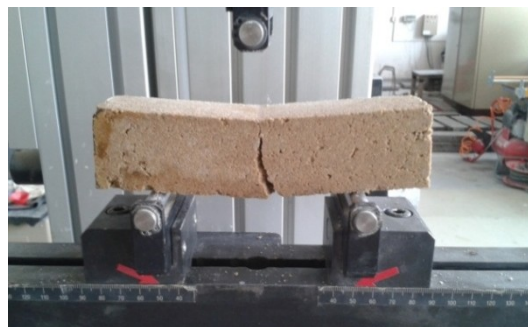
Obr. 22: Zkoušený trámeček po provedení zkoušky pevnosti v tahu za ohybu
