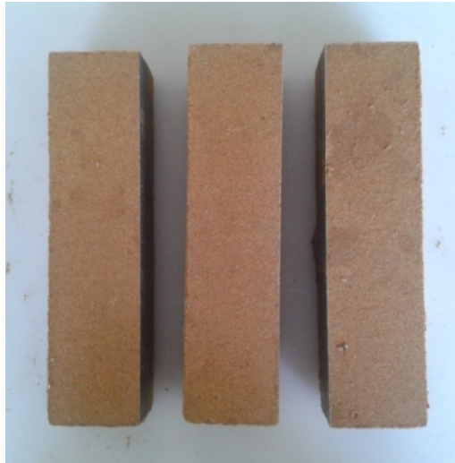
Obr. 18: Sada zkušebních trámečků velikosti 40x40x160mm
