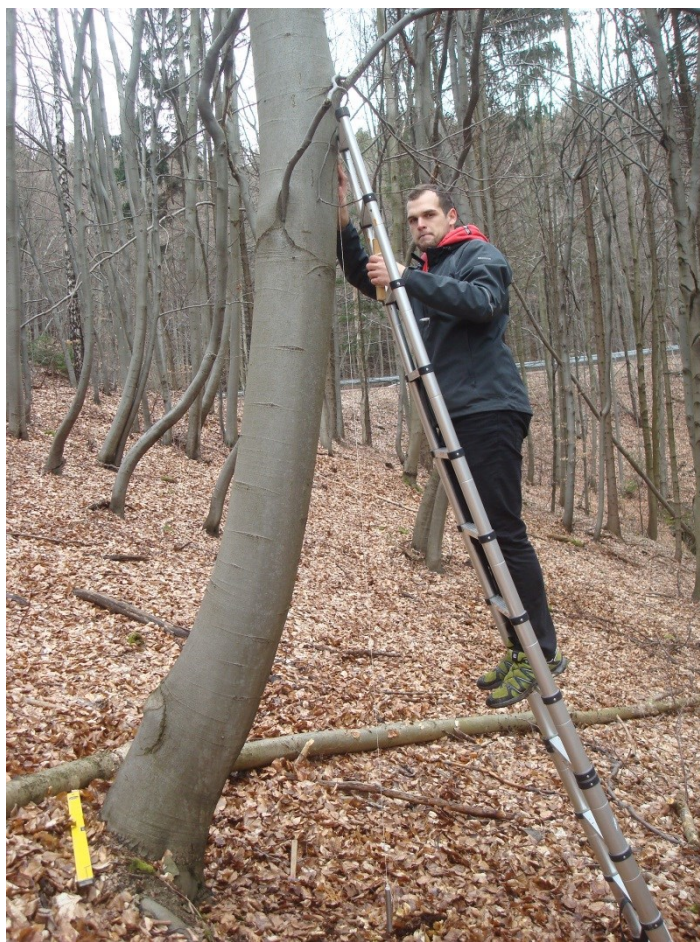
Obrázek 4.8 Uchycování olovnice na kmeni stromu
