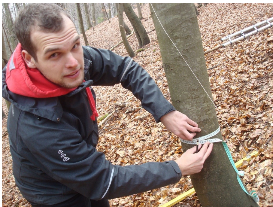
Obrázek 4.6 Měření obvodu kmene pomocí krejčovského metru
