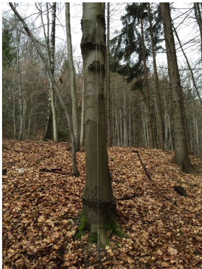
Obrázek 4.4 Svislá tečna vytvořena olovnicí
