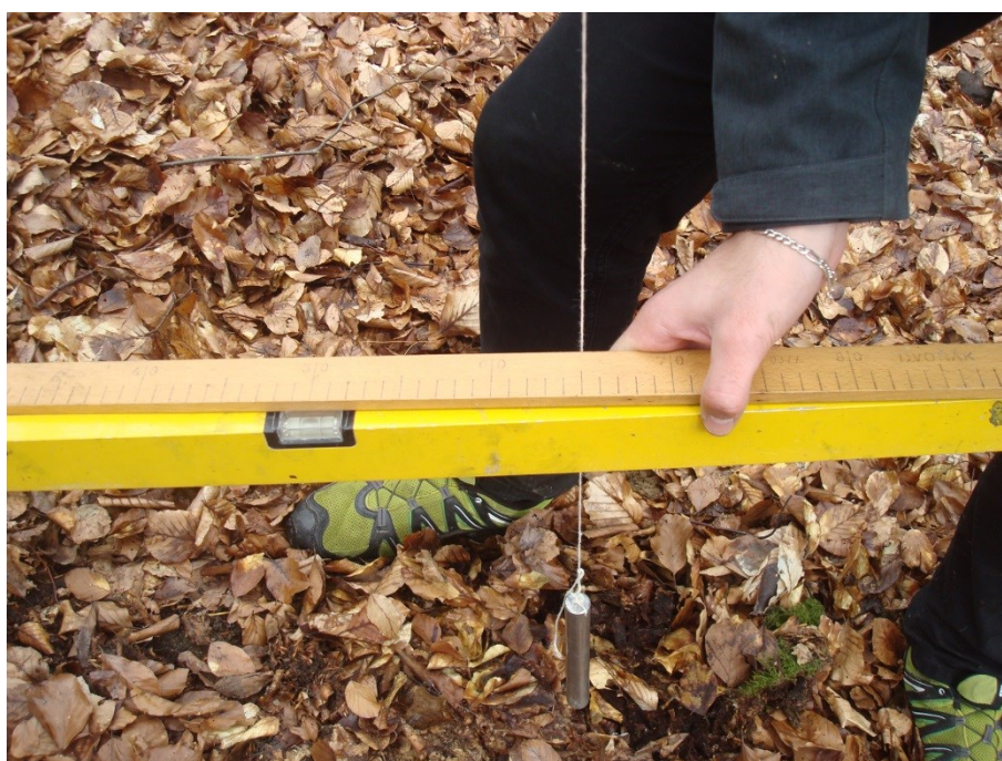
Obrázek 4.5 Odměření vzdálenosti tečny od kmene pravítkem s vodováhou
