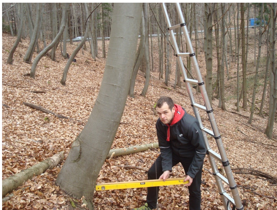
Obrázek 4.9 Měření vzdálenosti svislice od kmene
