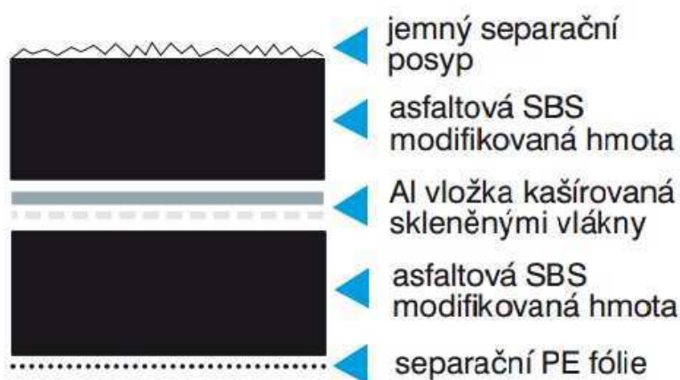
Obrázek 4 - Skladba GLASTEK AL 40 MINERAL (4)
