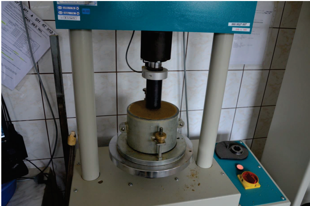
Obrázek 5: Provedení zkoušky Kalifornského indexu únosnosti
