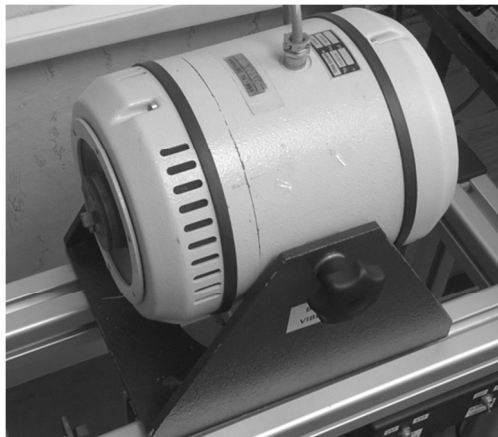
Obr. 4.8 Budič vibrací Tira TV 52110
