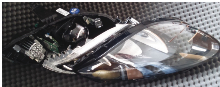
Obr. 7.1: Přední světlomet Jaguar XK s funkcí DRL, SMD LED Osram řady Advanced Power TOPLED Plus, 6500 K.
