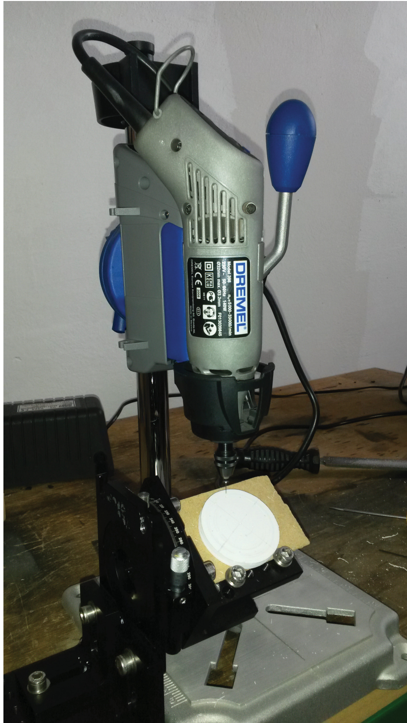
Obr. A.1: Pracoviště pro vrtání otvorů do výřezu z polystyrénu pro uchycení optických vláken v rámci segmentu
