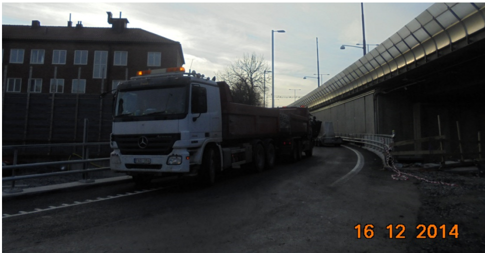
Obr. 4: Zatěžovací zkouška – 1. zatěžovací stav – dvě nákladní vozidla
