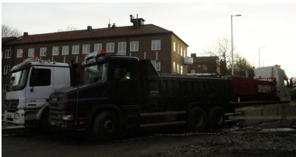
Obr. 5: Zatěžovací zkouška – 2. zatěžovací stav – čtyři nákladní vozidla
