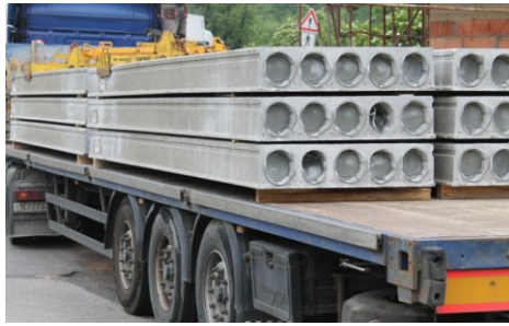
Obr. 15 - Doprava stropních panelů Spiroll [9]
