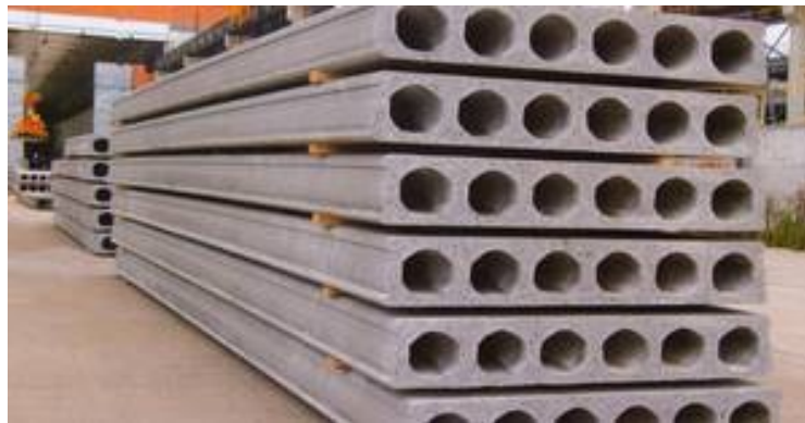
Obr. 16 - Ukázka skladování stropních panelů [9]
