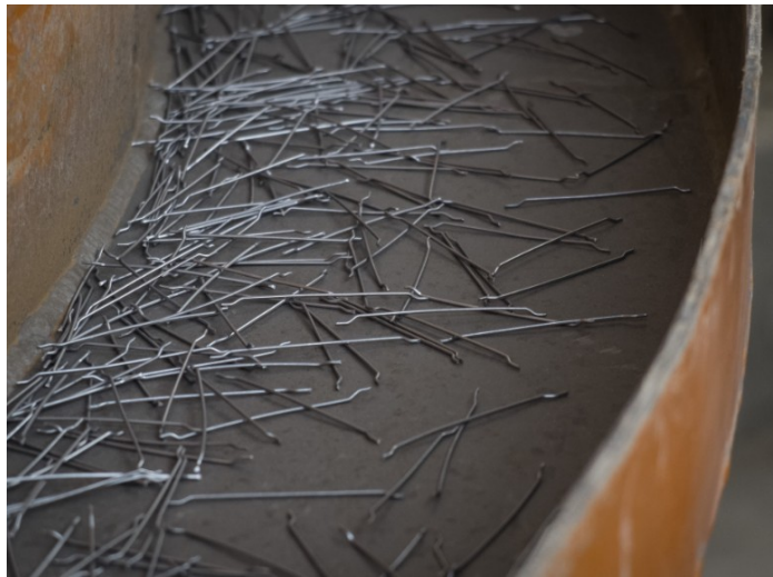
Obr. 15 - Ocelová vlákna (drátky) používaná pro drátkobeton (délka 60 mm)
