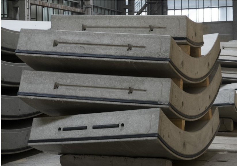
Obr. 16 - Těsnící pásy na segmentovém ostění
