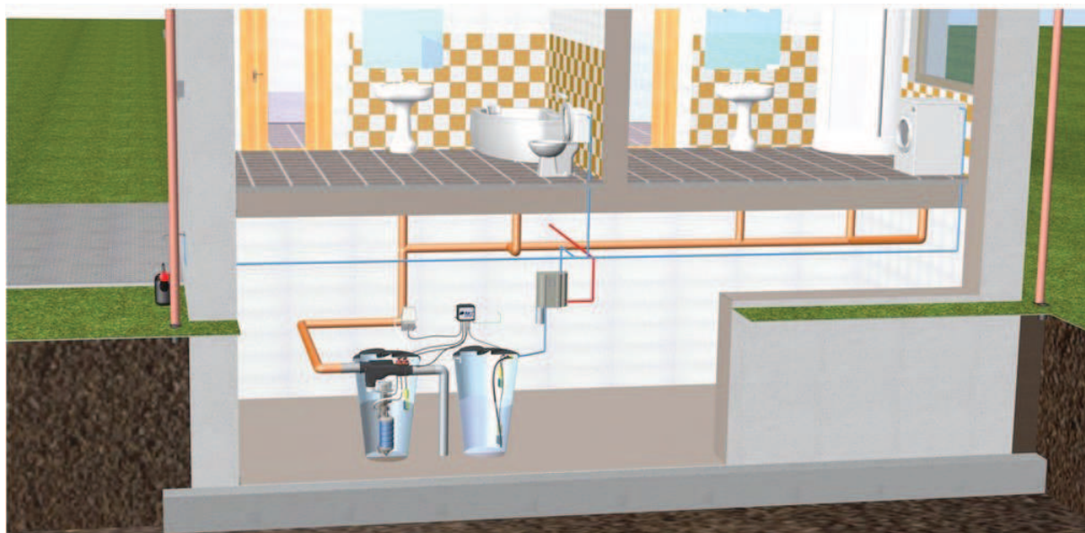
Obrázek 2: Umístění a princip akumulční nádrže [3]
