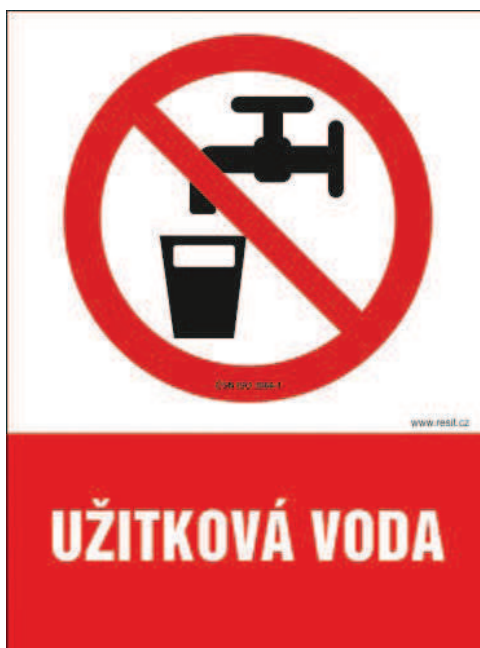
Obrázek 2: Označení míst výtoku šedé vody [51]
