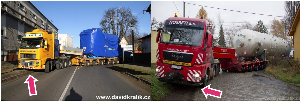
Obr. 3 Příklady nevhodného poloměru nároží [18]
