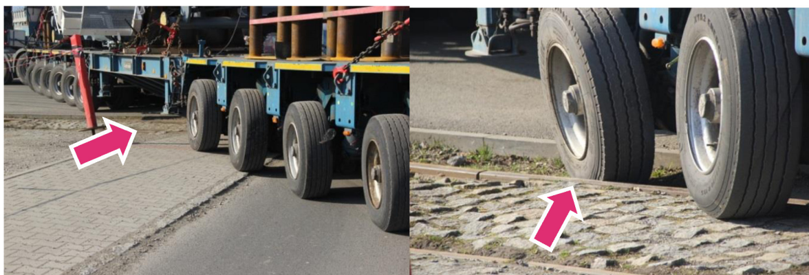
Obr. 16 Přejezd soupravy přes vlečku
