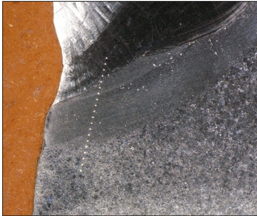
Obr. 4.1 Snímek dokumentující linii vtisků mikrotvrlosti HV 0,1 vzorku N5
