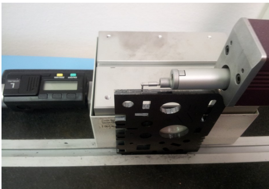
Obr. č. 25: Ukázka měření parametrů drsnosti
