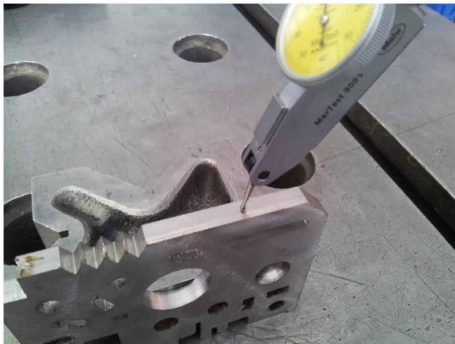
Obr. č. 24: Ukázka měření úchyly kolmosti
