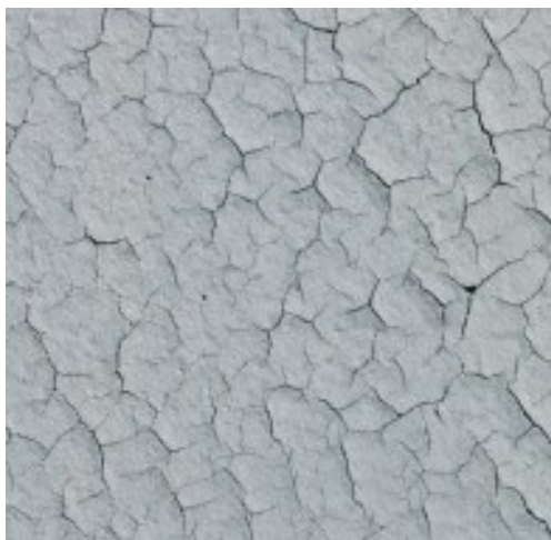
Obr.13 Bahenní praskání ESI – Zn nátěru [18]
