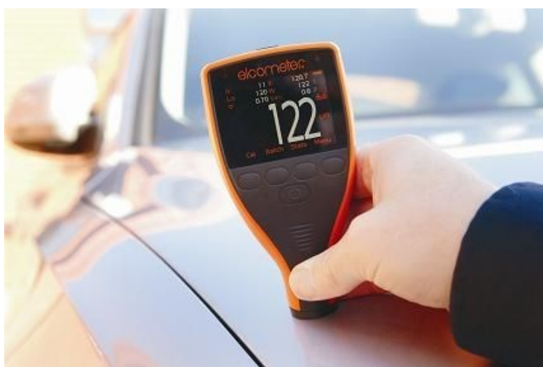
Obr.15 Měřicí přístroj Elcometer pro měření suchých tloušťek nedestruktivní metodou[19]
