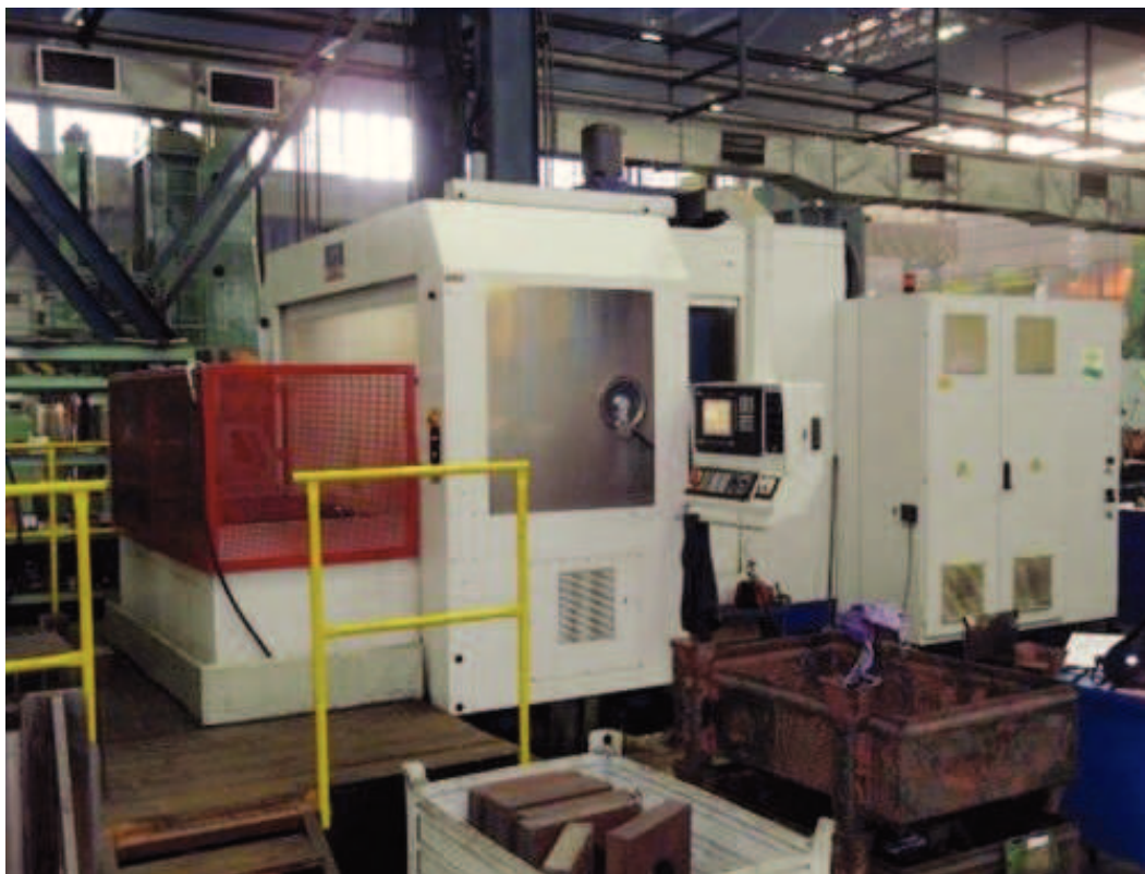
Obrázek 2.4 Obráběcí centrum MCFH 63
