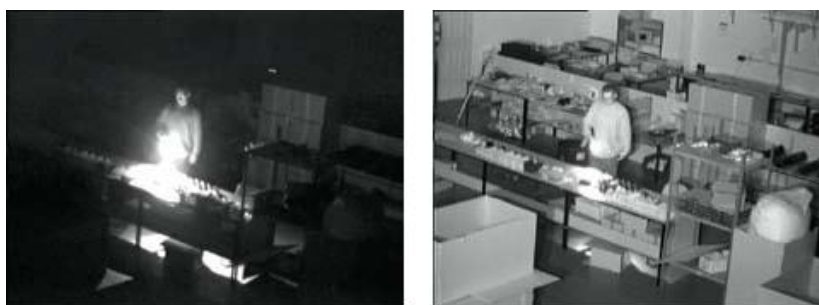
Obrázek 8: Vlevo snímek bez použití IR přísvitu, vpravo s IR přísvitem [8]
