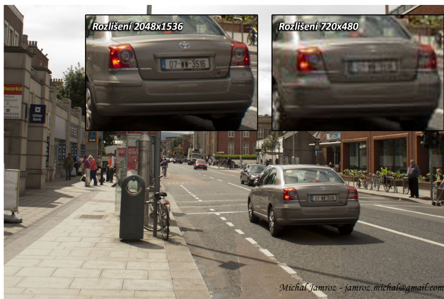
Obrázek 11: Srovnání čitelnosti výřezu SPZ při různých rozlišeních
