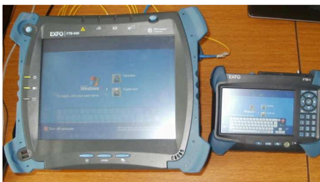
Obr. 4.3 Modulární platforma FTB-500 (vlevo) a měřicí přístroj FTB-860 (vpravo).
