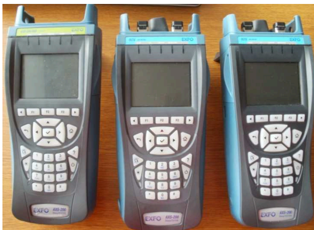
Obr. 4.2 Měřicí přístroj AXS 200/850 (vlevo) a dva měřicí přístroje AXS 200/350 (vpravo).
