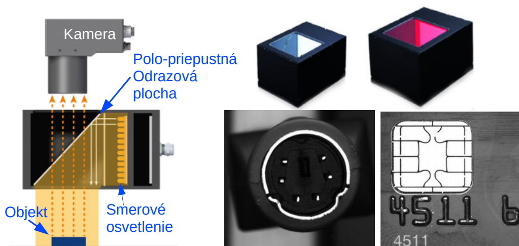
Obr. 46: Princíp a ukážka aplikácie koaxiálneho osvetlenia
