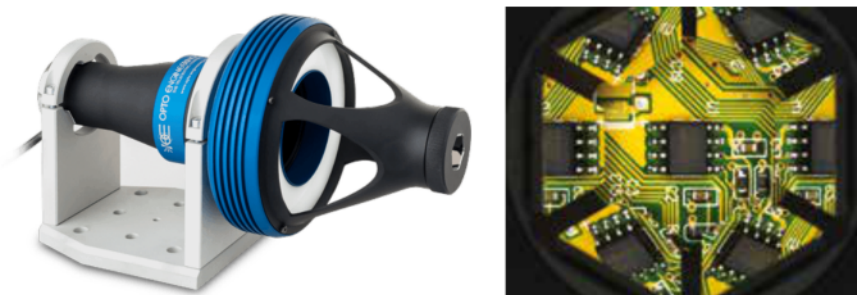
Obr. 42: Mikro-polyview objektív a jeho použitie [23]
