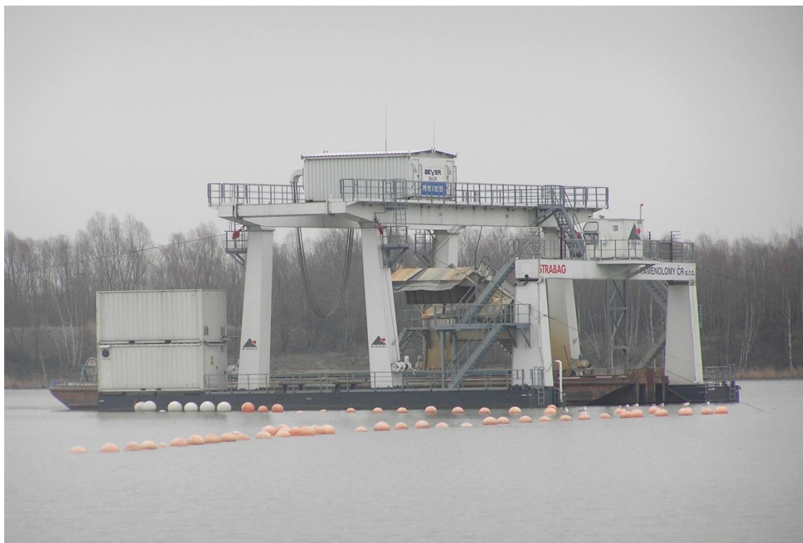
Obrázek 5: Plovoucí drapákové rýpadlo S 150 [vlastní zpracování]
