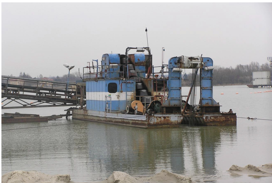
Obrázek 6: Plovoucí korečkový elevátor PKE 80 [vlastní zpracování]
