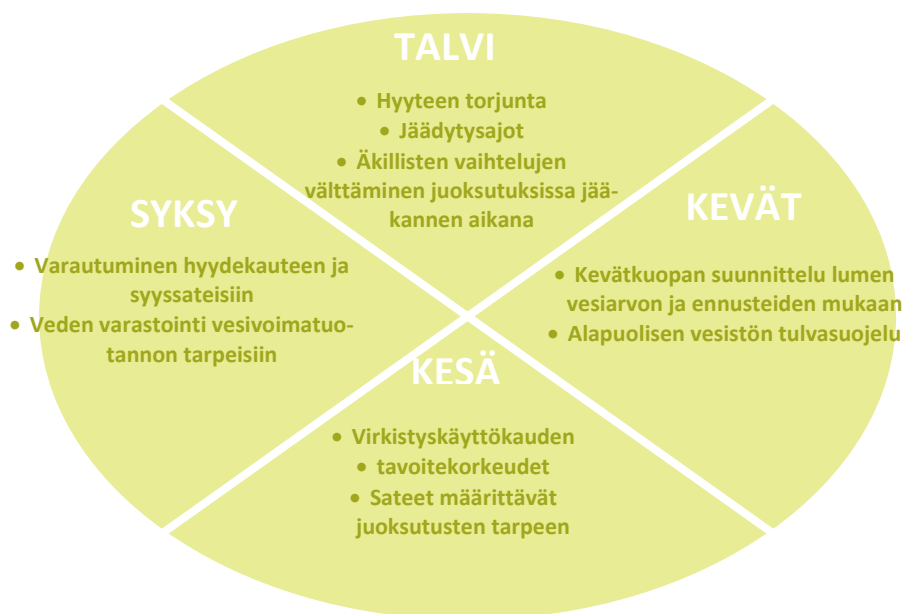
Kuva 1. Vesistöselälyssä huomioon otettavia seikkoja eri vuodenaikoina.
