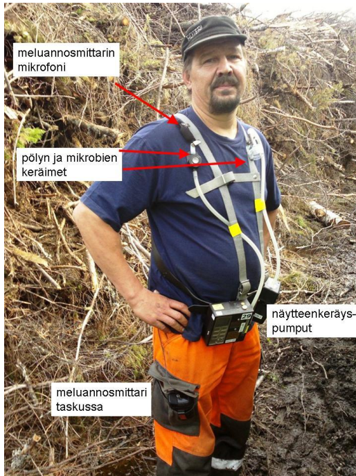
Kuva 1. Mittalaitteita työntekijään kiinnitettyinä. Kuva 2. Tärinäanturi istuimella.
