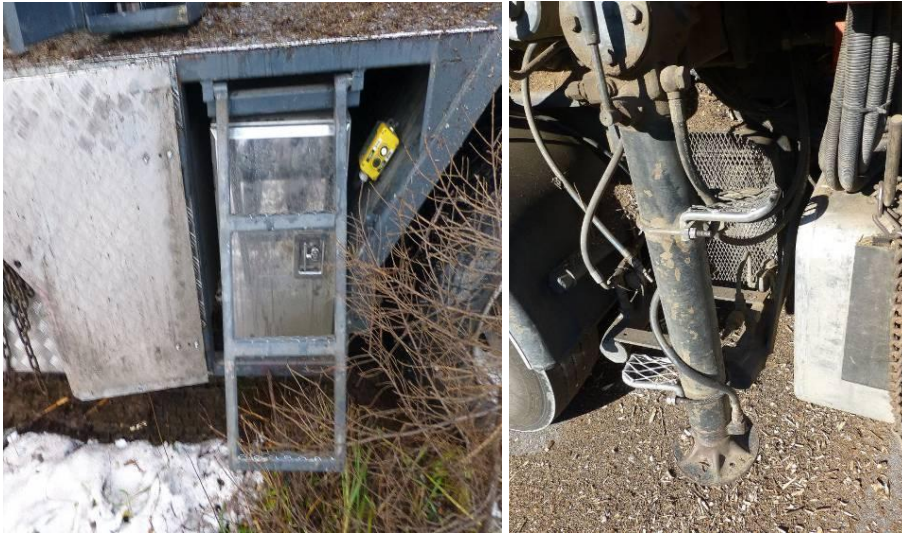
Kuva 14. Esimerkki hyvästä ja huonosta nousutien osasta koneen päälle.
