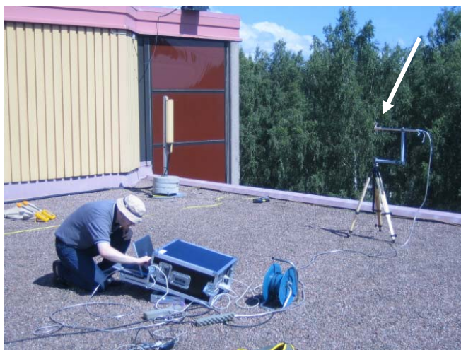
Kuva 12. Kapeakaistamittauksia tukiasema-antennin vieressä.
