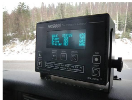
Kuvat 4 ja 5. CTI järjestelmän ohjausyksikkö ohjaamossa sekä ulkopuoliset ilmaletkut ja alennetun paineen vaikutus renkaisiin.
