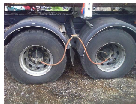
Kuvat 4 ja 5. CTI järjestelmän ohjausyksikkö ohjaamossa sekä ulkopuoliset ilmaletkut ja alennetun paineen vaikutus renkaisiin.
