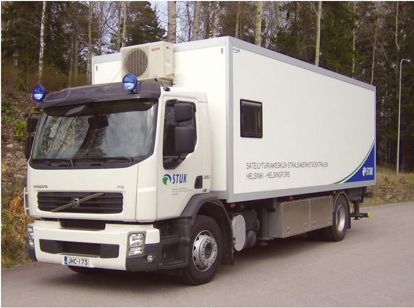
Kuva 10.1a. Kokokehomittauksissa käytettävä liikkuva laboratorio. Bild 10.1a. Det mobila laboratoriet som används för helkroppsmätningar. Fig 10.1a. The mobile laboratory used in the whole-body measurements.
