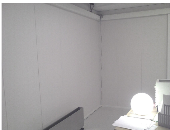
Kuva 2.6. Koehuoneen päty ja valvojan paikka. Vasemmalla on koetilanteessa 29 °C käytetty konvektori (patteri) ja oikealla lämmönlähde (75 W valaisin) simuloimassa valvojan lämpökuormaa.
