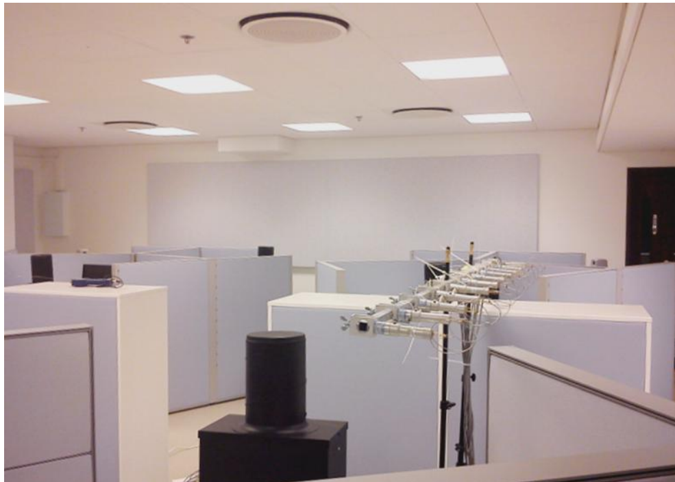
Kuva L2.1. Kuumapalloanemometrit mittaamassa virtausnopeutta käytävällä dummyn takana.
