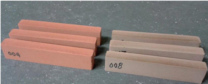
Figure 13: Briques à base des rejets de calamine, avant et après cuisson (Taha et al. 2016).
