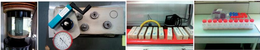
Figure 16: Élaboration d'éprouvettes de mortiers à base de rejets miniers de Zeïda et essais de durabilité et de lixiviation.
