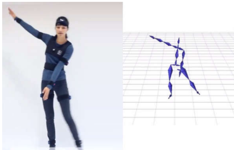
Figure 6: Ensemble de centrales inertielles de la marque Nexonar capturant une posture [41]
