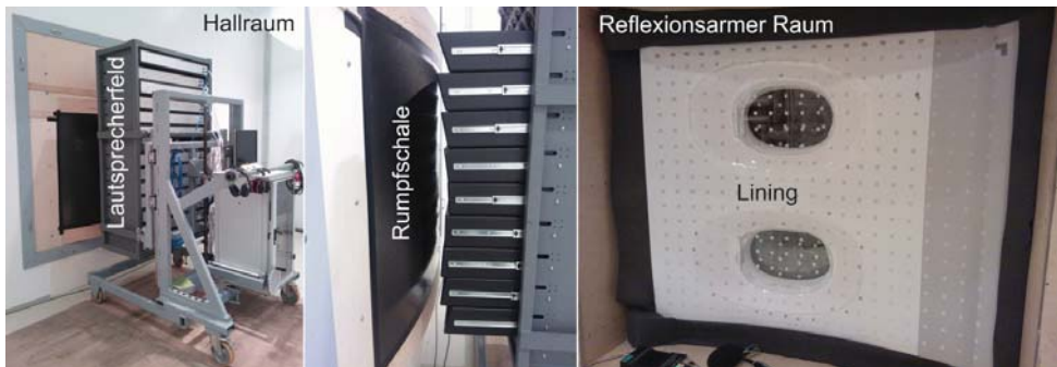
Abbildung 4: Versuchsaufbau im Transmissionsprüfstand mit dem Lautsprecherfeld vor der Rumpfschale aus Sicht des Hallraums (li. und mi.) und dem an die Rumpfschale gekoppeltem Lining aus Sicht des reflexionsarmen Raums (re.).
