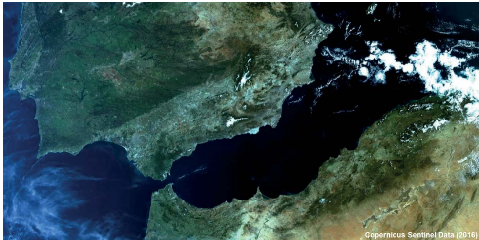
Abb. 1: Das westliche Mittelmeer, aufgenommen am 13. März 2016 durch das Ocean and Land Colour Instrument (OLCI) des Sentinel-3A-Satelliten. OLCI deckt einen Streifen von 1270 km Breite mit einer räumlichen Auflösung von 300 m in 21 Spektralkanälen ab und dient der Datenkontinuität des ENVISAT MERIS Instrumentes.
