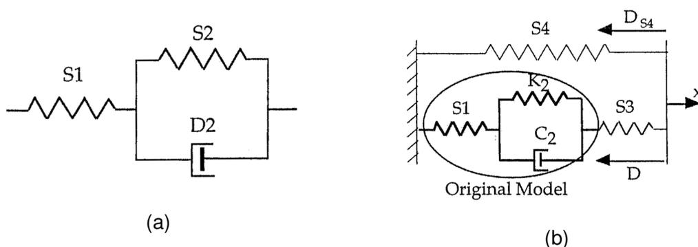
Abbildung 6.7.: Elastomermodelle nach GANDHI et al. [7, 8]
