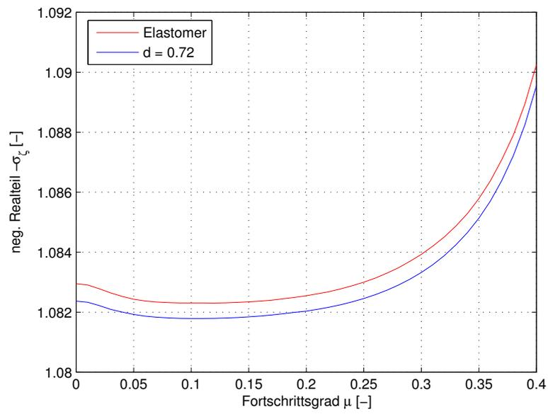
**Abbildung 6.11.:** Stabilität über  $\mu$  mit und ohne Elastomerdämpfer
