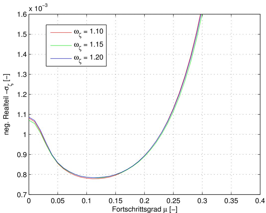
**Abbildung 5.6.:** minimaler negativer Realteil des Schwenkeigenwertes über  $\mu$ ,  $d_{\zeta} = 0$ ,  $R = 0$
