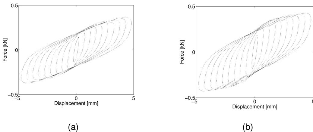
**Abbildung 6.2.:** Änderung der Hysterese durch Variation der Amplitude (a) 0 % Preload, (b) 10 % Preload [27]
