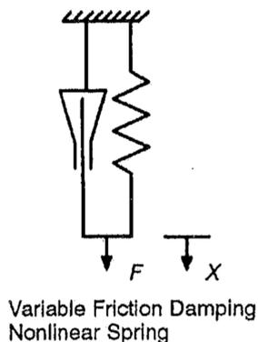
**Abbildung 6.6.:** Elastomermodell von BOEING [21]
