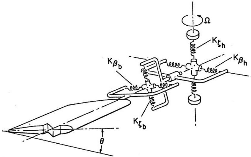
Abbildung 2.3.: Rotorblattanbindung nach Ormiston [20]
