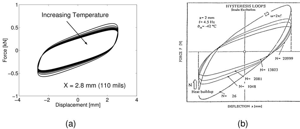
**Abbildung 6.1.:** Hysterese eines Elastomers in Abhängigkeit von (a) Temperatur [27] und (b) Anzahl der Perioden [11]
