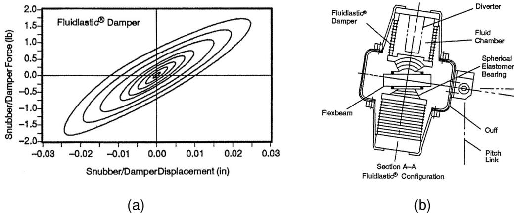
Abbildung 1.2.: Hysteresen (a) und Aufbau (b) eines fluidelastischen Dämpfers [21]
