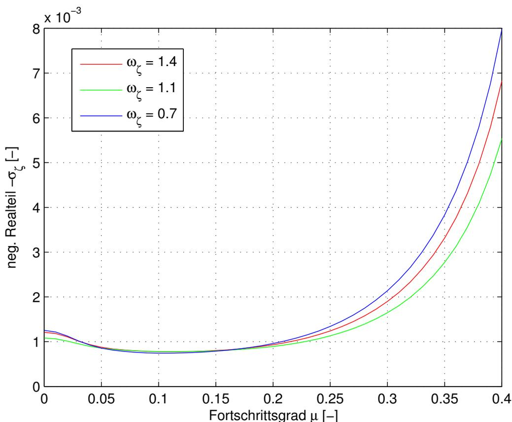
Abbildung 5.5.: negativer Realteil des Schwenkeigenwertes über  $\mu$ ,  $d_\zeta = 0, R = 0$
