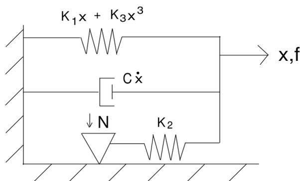
**Abbildung 6.8.:** Elastomermodell nach SNYDER [27]
