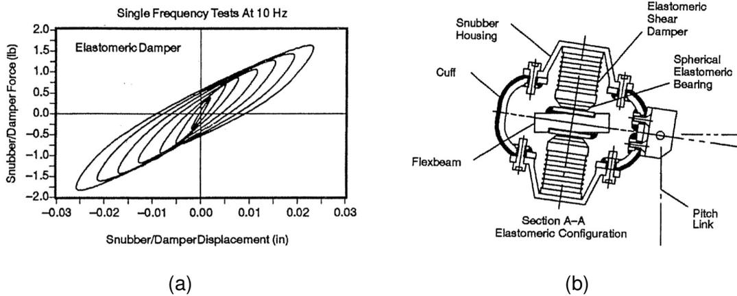
Abbildung 1.1.: Hysteresen (a) und Aufbau (b) eines Elastomerdämpfers [21]
