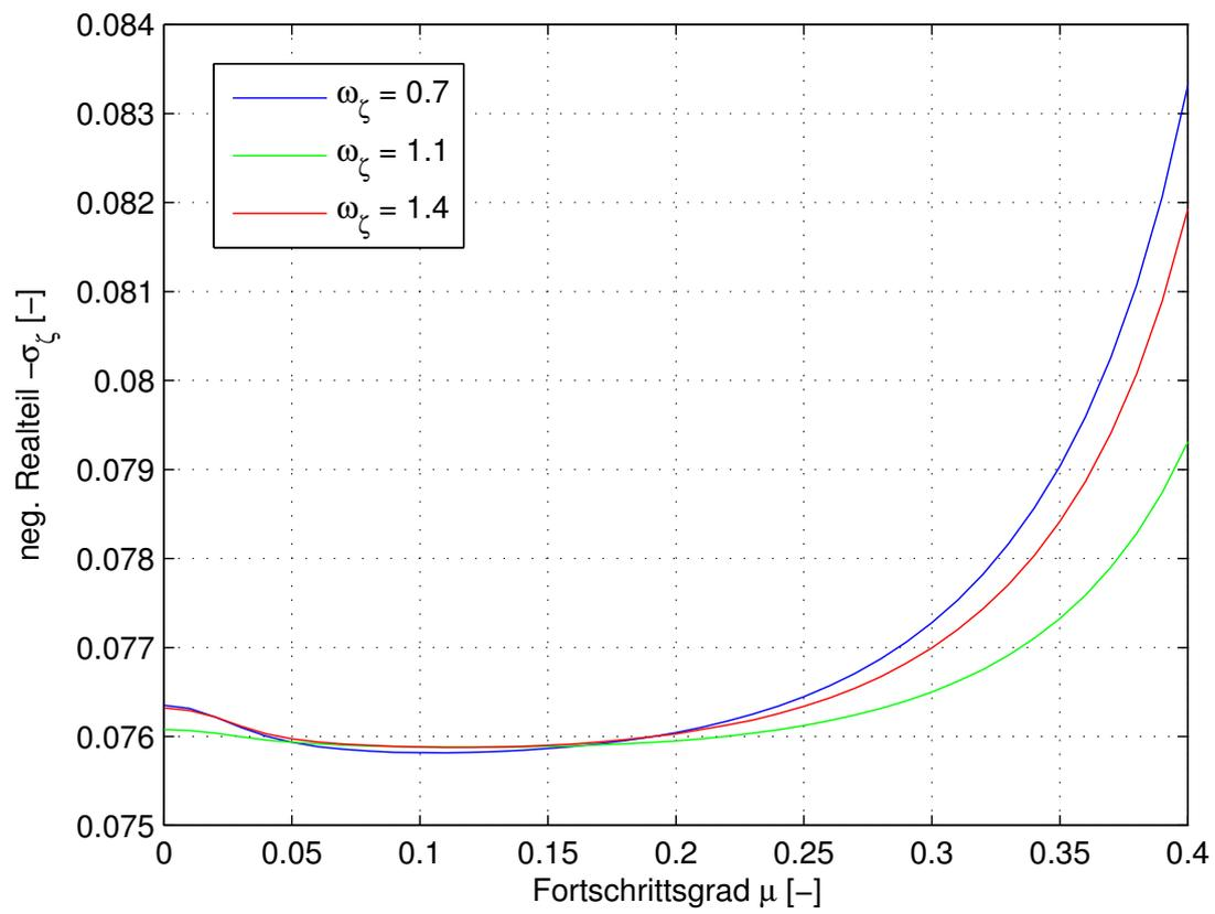
**Abbildung 5.7.:** negativer Realteil des Schwenkeigenwertes über  $\mu$ ,  $d_{\zeta} = 0.05$ ,  $R = 0$
