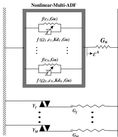
Abbildung 6.9.: Multi-ADF-Element mit Elastoreibelementen [23]
