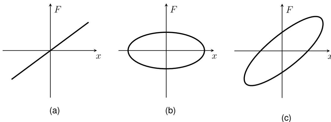
**Abbildung 6.5.:** Kraft über Auslenkung (a) Feder, (b) Dämpfer und (c) VOIGT-Element
