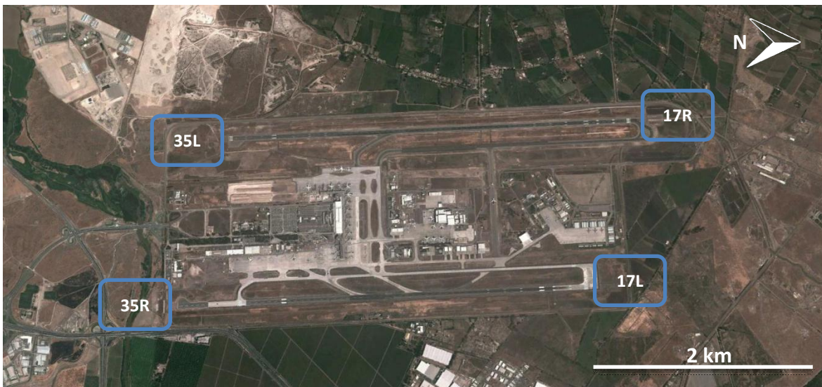
Fig. 3 - Configuración de pistas.
