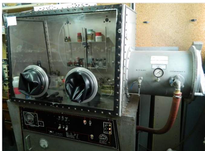
Figura III.14. Caja seca con guantes empleada en las medidas de VC.
