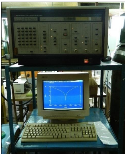
Figura III.6. Potencióstato PAR 273a utilizado para realizar las medidas de las curvas de polarización potenciodinámica.
