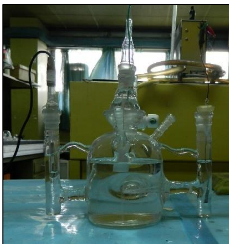
Figura III.8. Celda electroquímica empleada para realizar las medidas de impedancia electroquímica.
