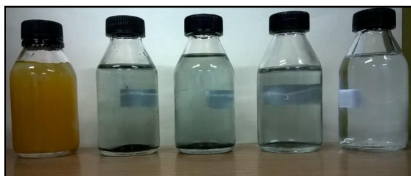
Figura IV.23. Soluciones de las experiencias de pérdida de peso para las muestras de acero luego de ser expuestas a H 2 SO 4 0,5 M a 60°C, por 24 h, en ausencia y en presencia de las diferentes concentraciones de I. De izquierda a derecha: 0 a 120 μM de I.
