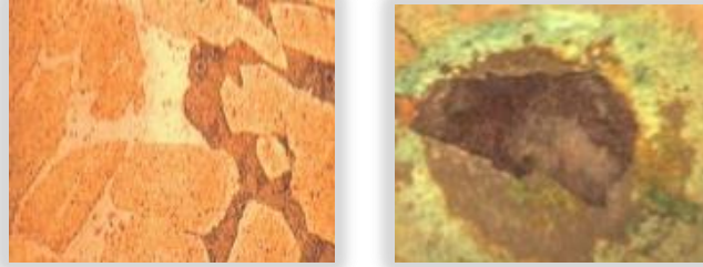
Figura 1.2. Fotos que muestran ataque corrosivo selectivo (dezincificación y desniquelación).
