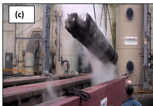
Figura IV.1. (a) Etapas del proceso de galvanizado en caliente. (b) y (c). Estructura de acero luego de la limpieza o decapado ácido.
