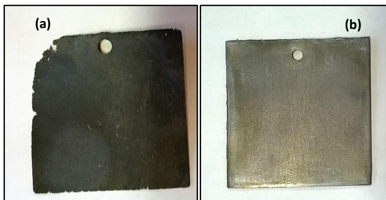
Figura IV.24. Chapas de acero luego de ser expuestas a \text{H}_2\text{SO}_4 0,5 M, por 24 h a 60^\circ\text{C} , en ausencia (a) y en presencia de 120\ \mu\text{M} de I.
