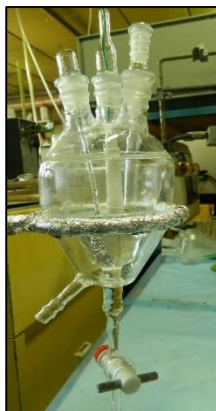
Figura III.5. Celda de forma cónica empleada para registrar las curvas de polarización potenciodinámica.
