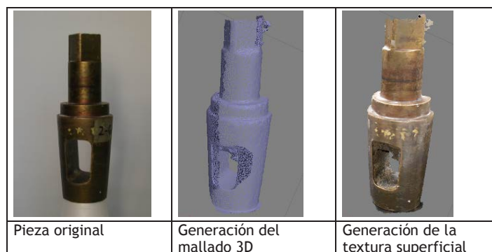
Figura 4 – Secuencia seguida empleando Agisoft Photoscan
