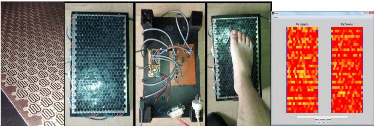
Figura 4. Placa sensora, Prototipo final del Pedígrafo digital e Interfaz gráfica.
