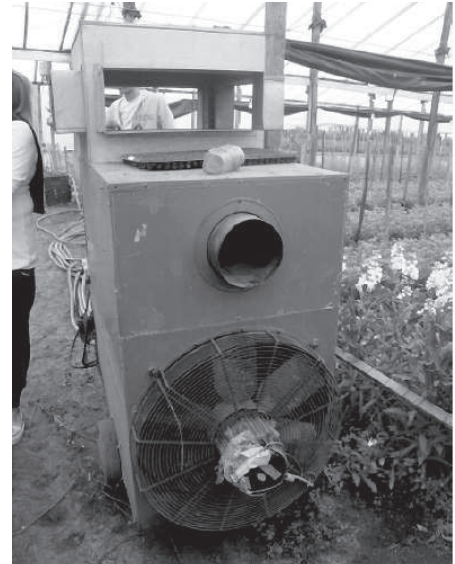
Foto 3. Equipo de calefacción a diésel
