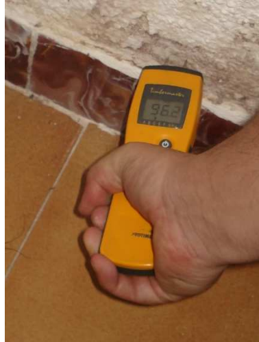
Fotografía 05: Porcentaje de humedad por capilaridad
