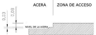
DETALLE DE LA SECCIÓN DEL ESCALÓN DE ACCESO AL EDIFICIO
