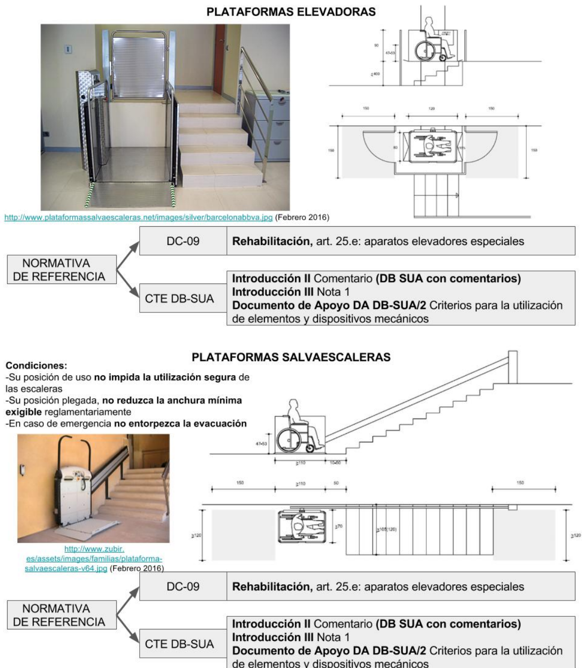
FIGURA 17.- DIMENSIONES APARATOS ELEVADORES ESPECIALES / FUENTE: ELABORACIÓN PROPIA A PARTIR DE LA NORMATIVA VIGENTE
