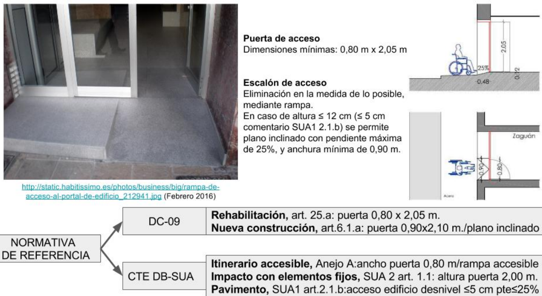
FIGURA 18.- DIMENSIONES ACCESO AL EDIFICIO / FUENTE: ELABORACIÓN PROPIA A PARTIR DE LA NORMATIVA VIGENTE
