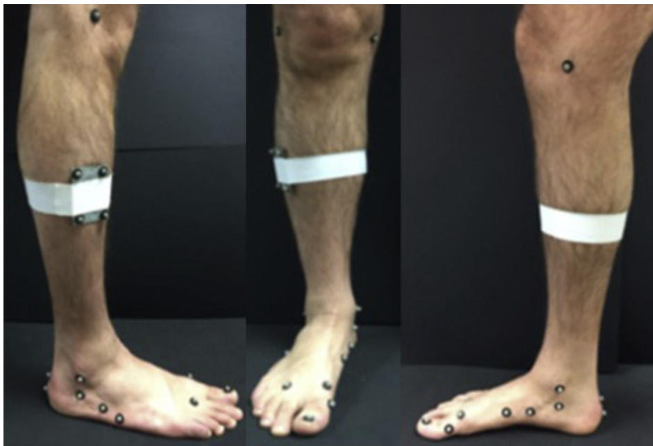
Figura 1 Sistema de marcadores utilizado para el análisis cinemático y cinético de los individuos.
