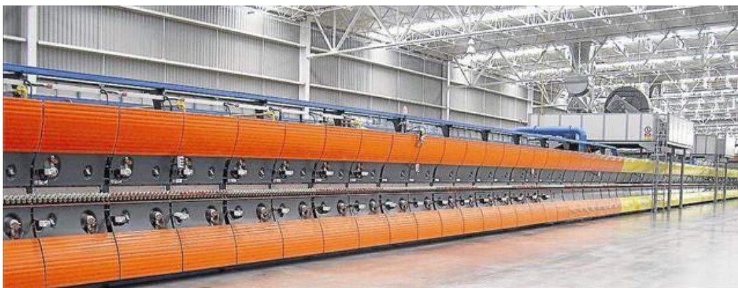
Figura 1.3.5. Horno cerámico. (Fuente: SACMI).
