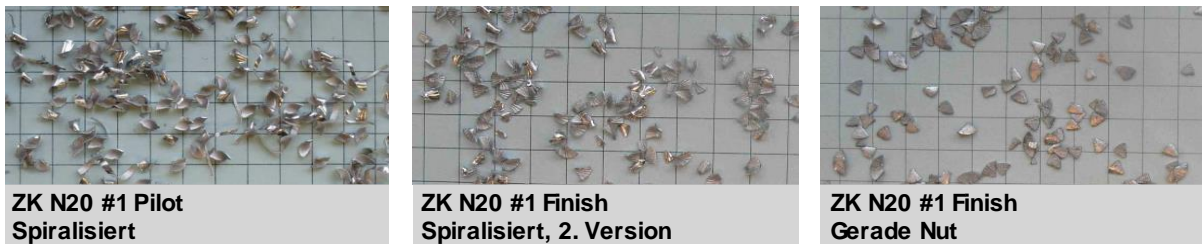
Abbildung 5.24: Späne nach Bearbeitung des Werkstücks mit den in Tabelle 5.9 genannten Prozessparametern
