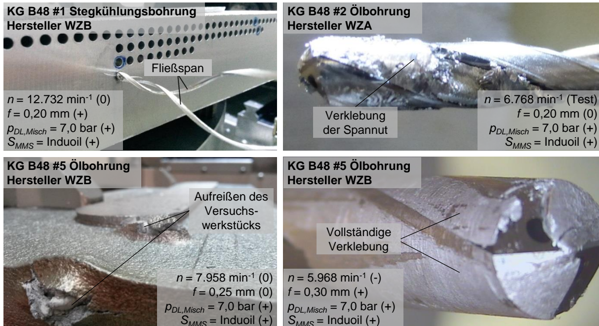
Abbildung 5.27: Auswahl an Werkzeug- und Werkstückschäden im Rahmen der Versuche
