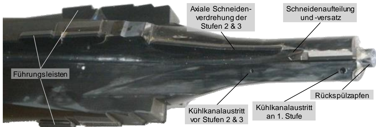
Abbildung 5.26: Detailaufnahme des Finish-Werkzeugs für die Injektorbohrung des ZK N20
