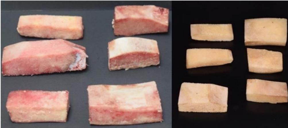
*Figura 7 (a) Muestras antes de la inmersión en agua. (b) Muestras luego del proceso de limpieza inicial*
