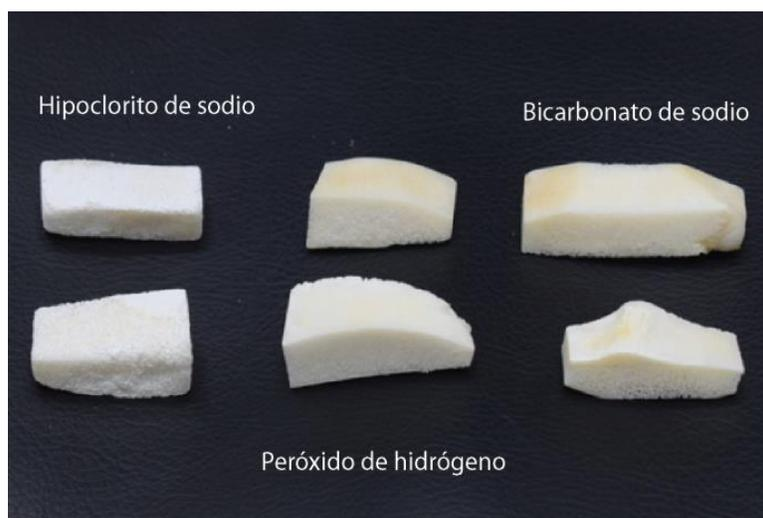
*Figura 12 Muestras óseas después del proceso de limpieza con sustancias*
