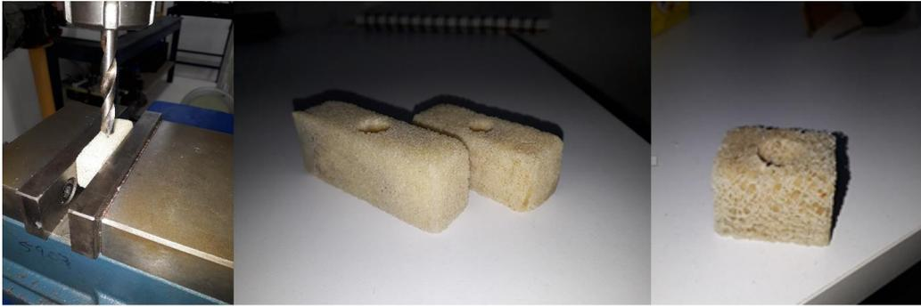
*Figura 10 Primeras 3 muestras fabricadas con perforación que simulará la cavidad alveolar*
