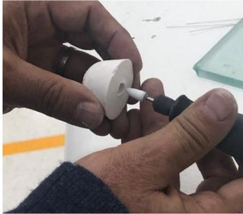
*Figura 14 Proceso de fresado del molde hasta la profundidad proporcional con la raíz del diente*
