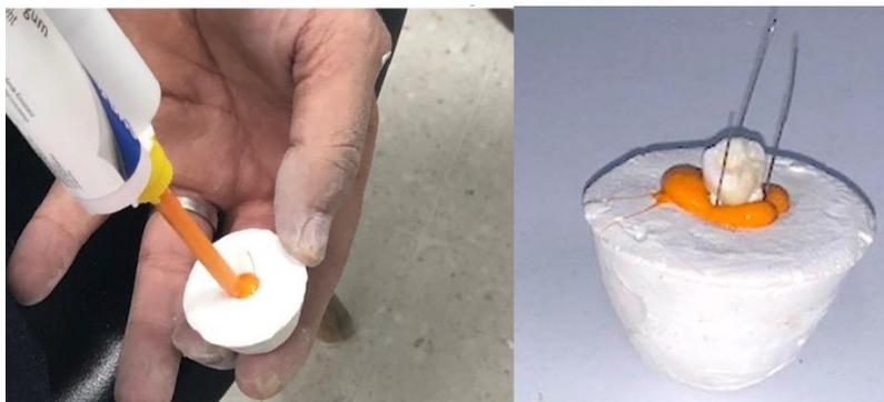
*Figura 19 (a) Aplicación de mezcla de silicona en el molde de yeso 2. (b) Inserción del diente en la cavidad del molde.*
