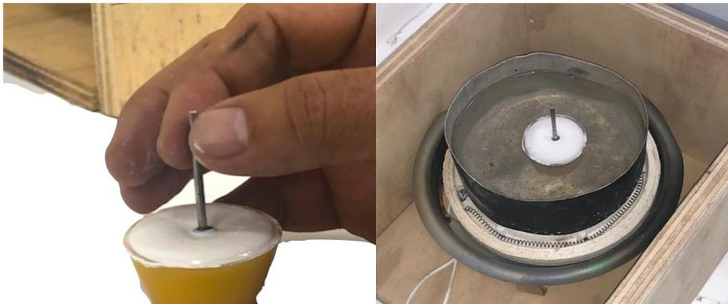
*Figura 13 (a) Yeso vertido en vaso Dappen con broca cónica insertada. (b) proceso de endurecimiento en agua caliente*
