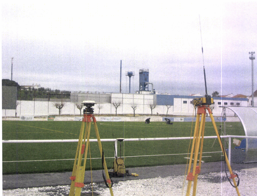
Figura 3.5 - Instalação da estação de correcção diferencial dGPS-RTK, junto ao campo de Futebol.
