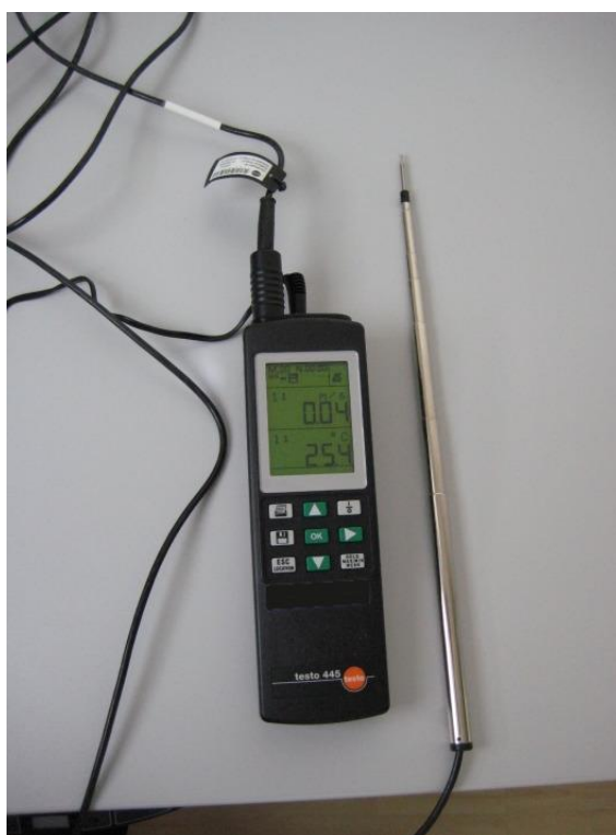
Figura 17 - Anemómetro de esfera aquecida (direita) e datalogger
