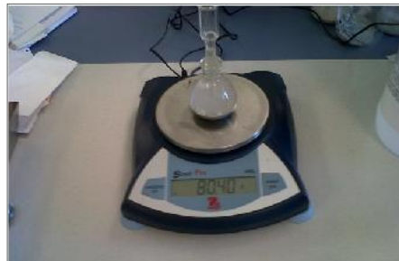
Figura 4. 18. Picnómetro para determinar la densidad real
