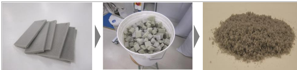
Figura 5. 3. Secuencia de obtención de la espuma gris triturada
