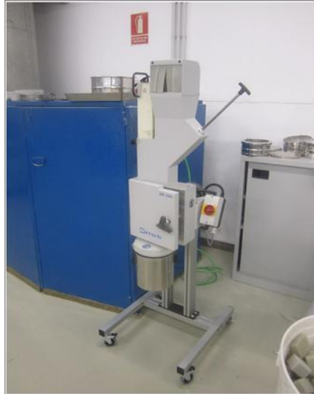
Figura 5. 2. Molino con tamizadora RESTCH SM100
