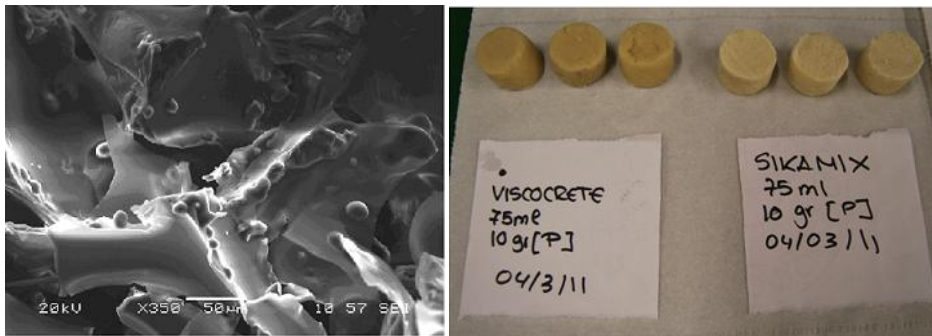
Figura 9. 5. Imagen SEM del poliuretano blanco con aditivo Sikamix y probetas de poliuretano con aditivos
