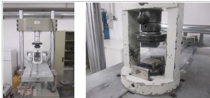
Figura 4. 13. Prensa multifuncional de rotura a flexión y a compresión
