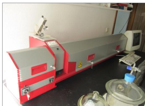
Figura 4. 4. Analizador láser para determinación de la granulometría
