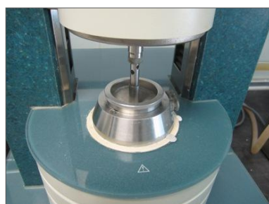
Figura 8. 4. Ensayo en el viscosímetro rotacional de la pasta YPW
