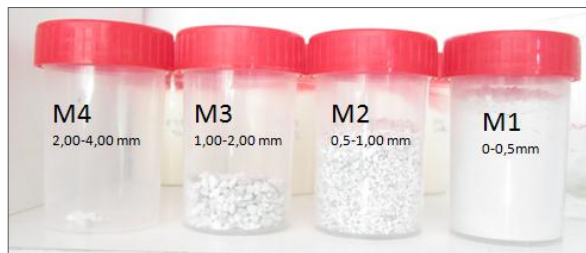
Figura 5. 12. Fracciones del yeso ensayado por espectroscopía infrarroja
