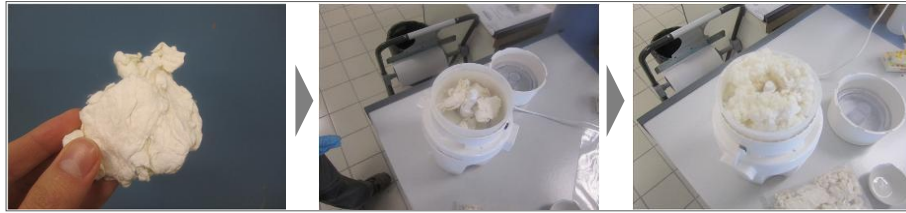
Figura 5. 9. Proceso de triturado de las fibras de celulosa
